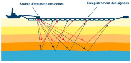
Le principe de la sismique est simple : on provoque de légers ébranlements (chute d'un poids, petite explosion...) et on suit les signaux ainsi émis, qui se réfléchissent sur certaines discontinuités géologiques.
